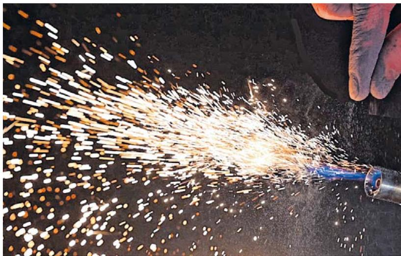
**Brennender Eisenstaub:** Wenn Eisen verbrennt, setzt es Wärme frei – ganz ohne CO<sub>2</sub>.
